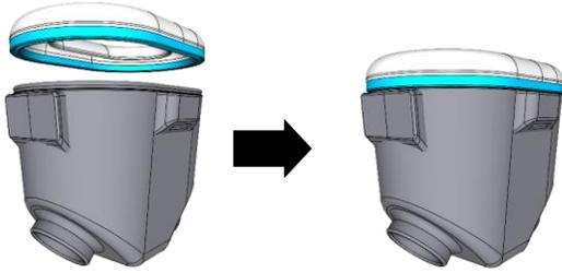
**2** Acoplar la válvula de salida
